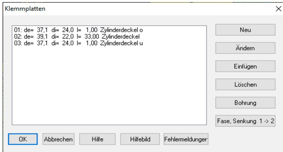
Nachteilig ist diese Aufspaltung der Klemmteile bei der Berechnung des Setzbetrags  $f_z$ , weil die neuen Klemmplatten keine Trennflächen haben. Deshalb kann man jetzt unter Bearbeiten\Last die Anzahl der Klemmplatten mit Trennfugen eingeben. Diese Eingabe ist temporär und wird nur für die Berechnung des Setzbetrags  $f_z$  verwendet.
