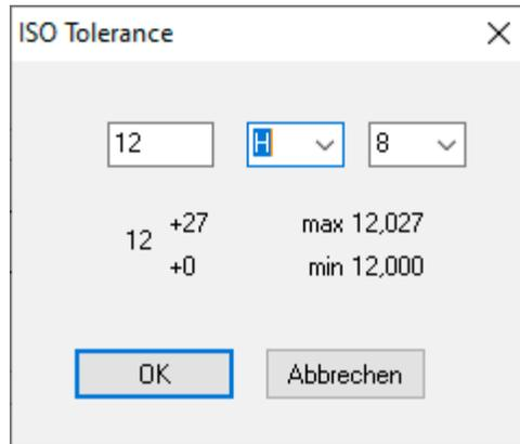
Mit den „..“-Buttons bei der Toleranzeingabe werden ISO-Toleranzfelder zur Auswahl angezeigt. Bei Innendichtung waren Kleinbuchstaben für Wellentoleranzen statt Großbuchstaben für Bohrungstoleranzen angezeigt, das wurde korrigiert. Man kann das ISO-Toleranzfeld auch direkt eingeben, DI1 berechnet dann Höchstmaß und Mindestmaß.
