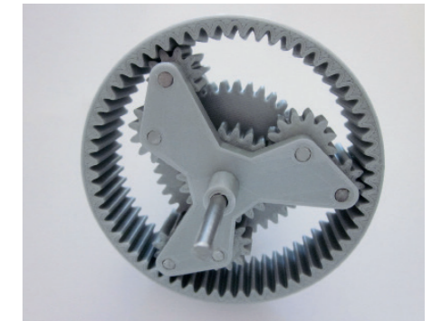
03 Ravigneaux-Planetengetriebemodell fertig montiert
